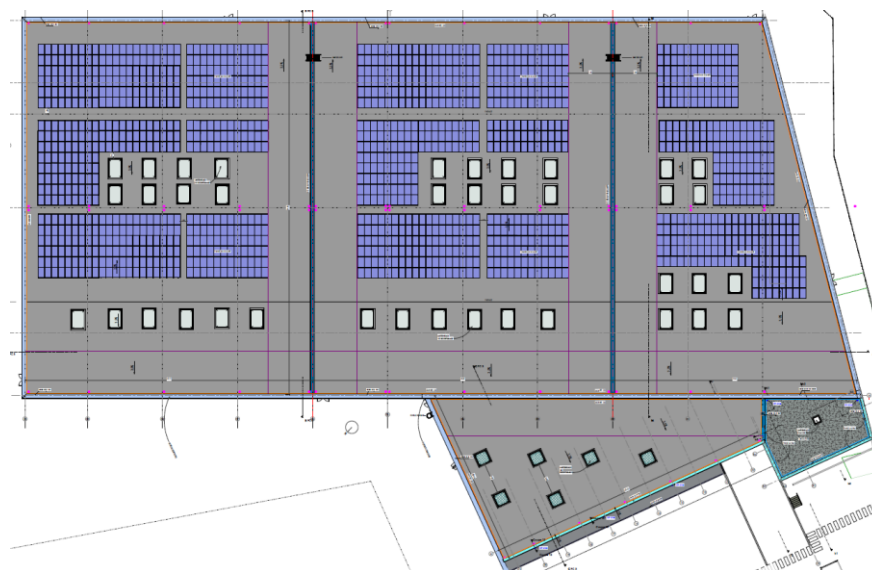
Figure 2: Panneaux PV sur site
